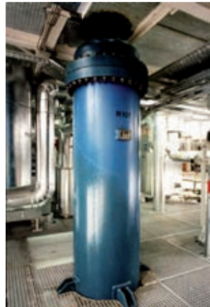
图4：可生产200 Nm 3 /h代用天然气产品的TREMP™半商业反应器
